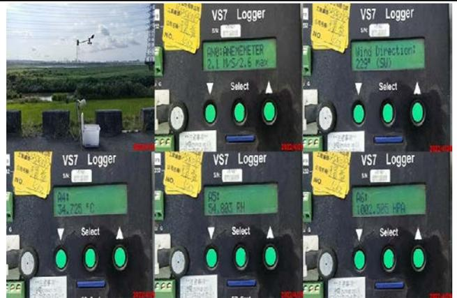
現地量測風速、風向、溫度、溼度、大氣壓力數值。
