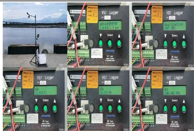
現地量測風速、風向、溫度、溼度、大氣壓力數值。
