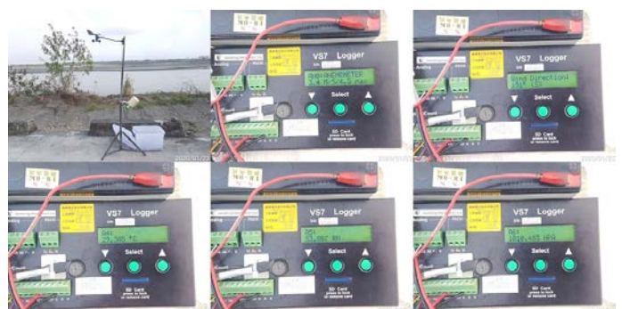
現地量測風速、風向、溫度、溼度、大氣壓力數值。
