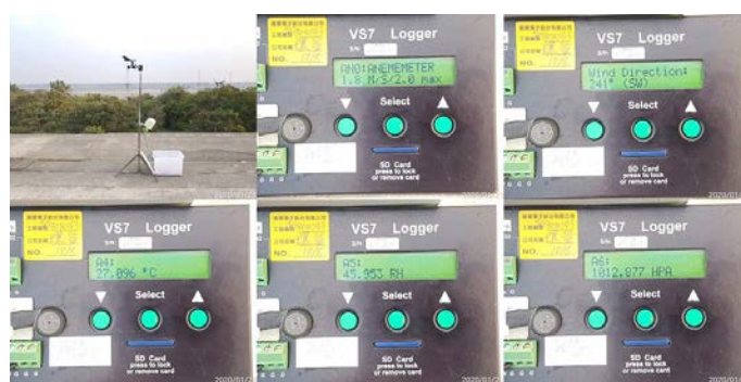
現地量測風速、風向、溫度、溼度、大氣壓力數值。
