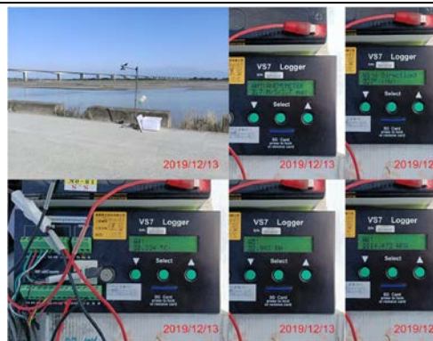
現地量測風速、風向、溫度、溼度、大氣壓力數值。
