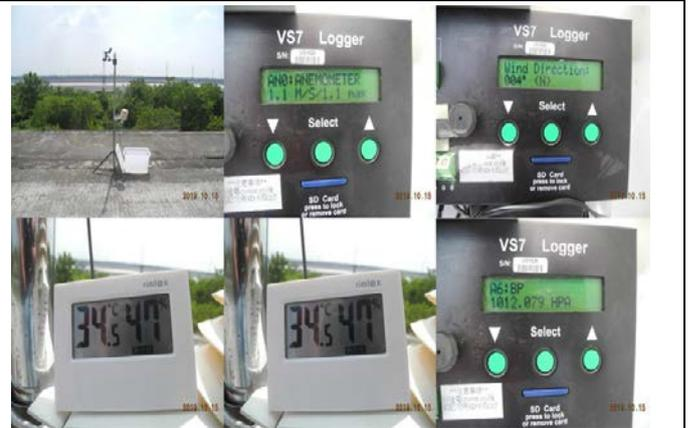
現地量測風速、風向、溫度、溼度、大氣壓力數值。
