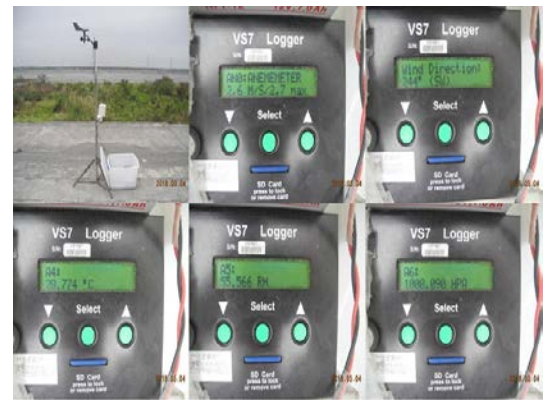
現地量測風速、風向、溫度、溼度、大氣壓力數值。
